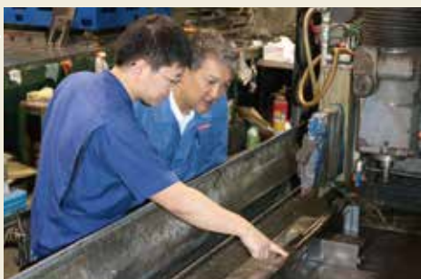
HIP処理合金金型研削加工工程
