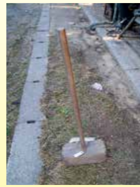
かくつち角槌 (堤体をたたいて締め固める道具)
