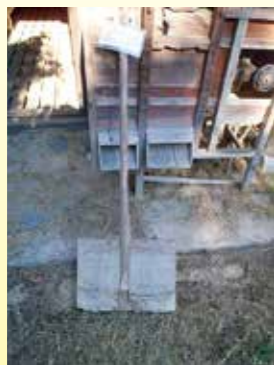
たたき台 (堤体の表面をたたいて締め固める道具)
