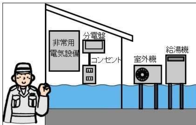
電気整備の浸水対策
