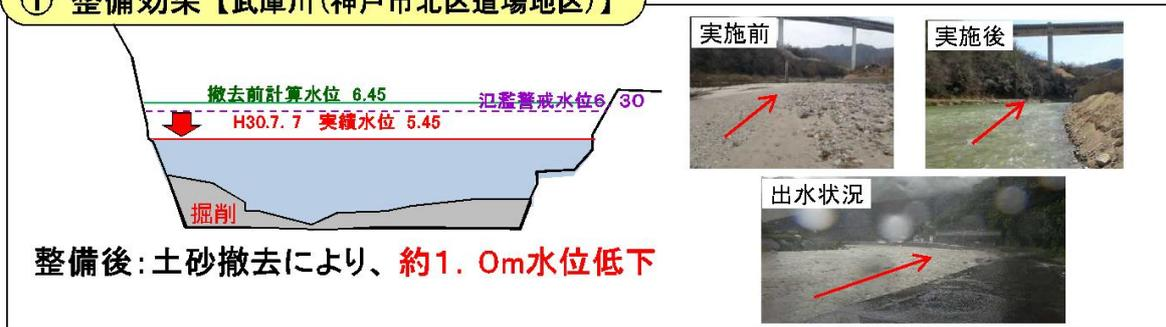
図 3-2 平成30年7月豪雨における武庫川道場水位観測所の水位低減効果
