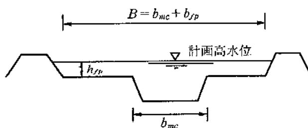
ただし、 $h_{fp}$  は高水敷上の計画高水位での水深、 $b_{mc}$ 、 $b_{fp}$  は低水路幅、高水敷幅であり、植樹を許可できる区域の平均的な河道形状から、死水域を除いた横断形状で与える。
