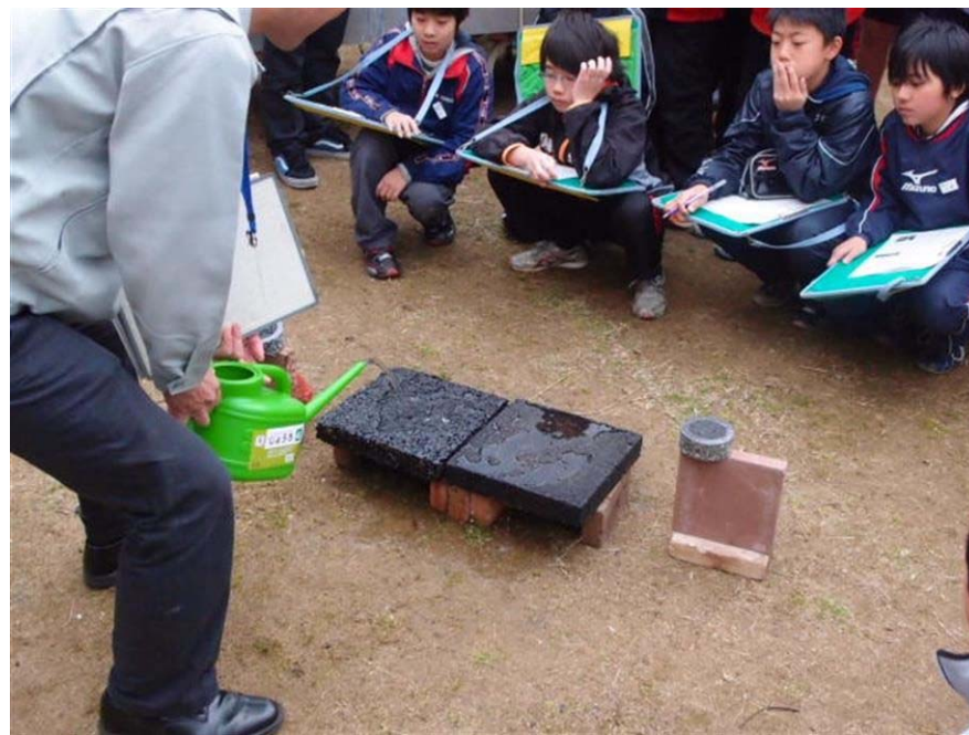
透水性アスファルトの違いを 実際に水をかけて説明
