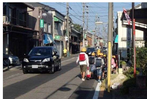
図 4.2 路肩に設置された電柱による通行阻害 (出典：国土交通省 HP)
