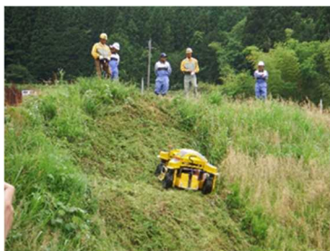
無線遠隔草刈機による法面除草
