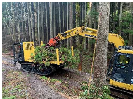
図 31 土砂と接していない枝葉だけを搬出し
