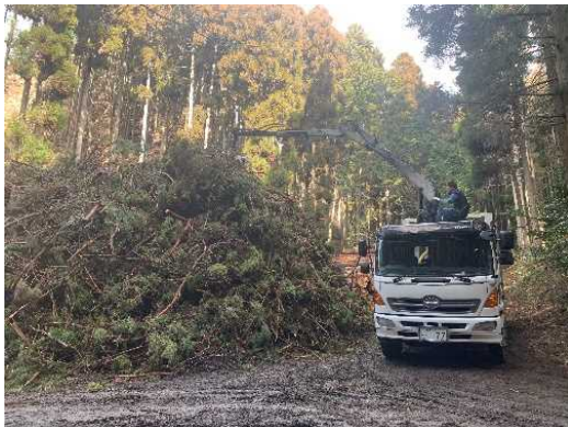
図 33 コンテナ車のローダによる積み替え
