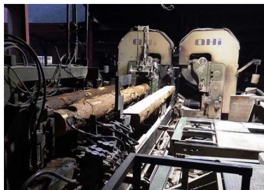
図 16 大径材が挽けないツインバンドソー
