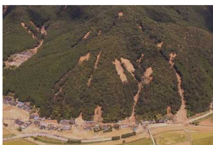
谷頭部の凹型斜面で多発した崩壊 (丹波市市島町前山川流域 国土地理院撮影)
