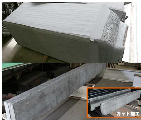
鍛造された特殊鋼 (上段:鍛造前、下段:鍛造後)
