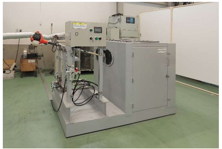
自社開発の刈払機衝撃試験機
