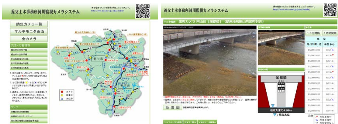
図 6.2.2 兵庫県河川監視システム（養父土木事務所河川監視カメラシステム）の例 （左：トップ画面、右：自動更新されるモニターカメラの映像例） ( http://www.mizumori.jp/yabu/cameras.html )
