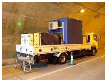
トンネル点検（レーザー打音）
