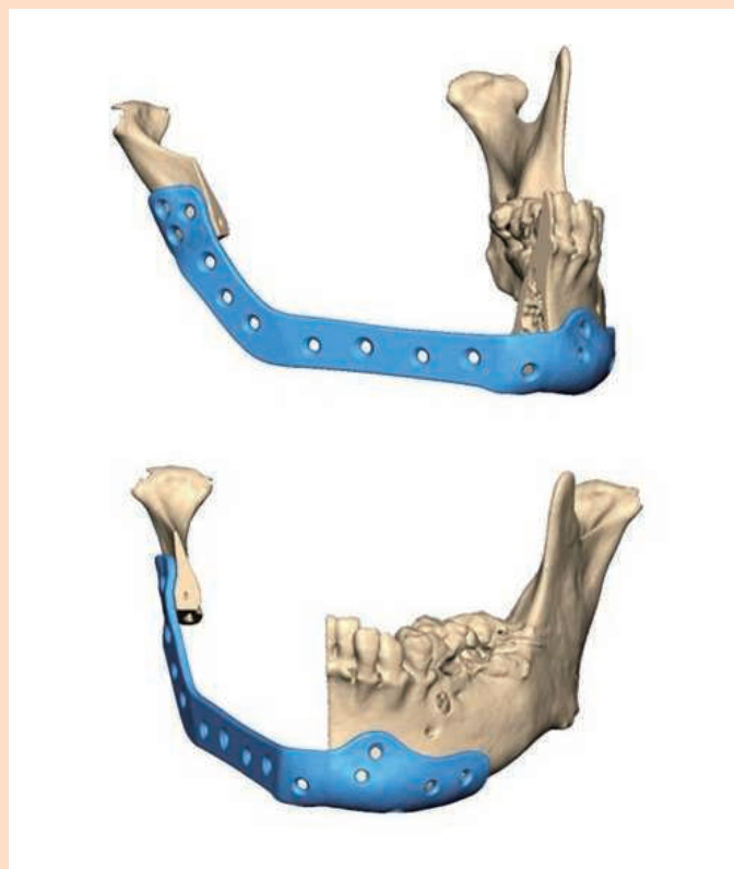
図5：コンピュータ上でのプレートデザイン
