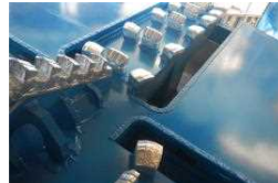
地中を掘削する刃(ビット)
