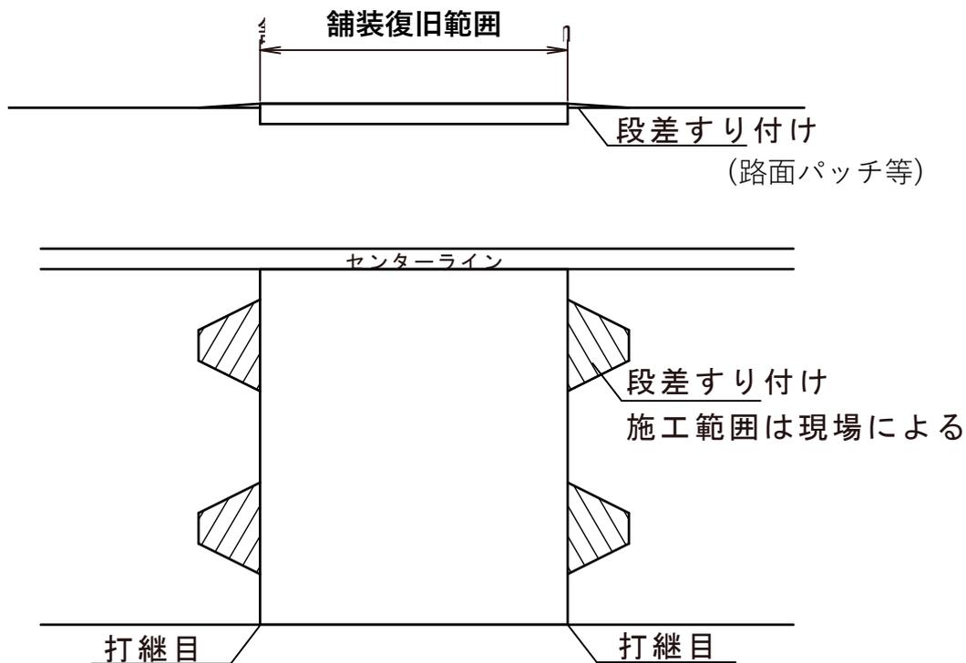
② 施工継ぎ目部では、既設舗装の側面にプライマーを十分塗布し、接着を高めること。
