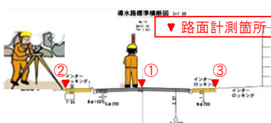
道路の高さの測量は、道路センター(①)と歩道の両端(②③)の計3箇所を20m毎に計測
