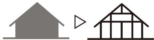
母屋の軸組と屋根だけを残しそのほかは減築する計画とする。三木家の骨髄である軸組の躯体を見せ屋外と連続させた新しい空間をつくることでまちとつながりを持たせた拠り所となる。
