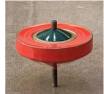
姫路独楽の原材料は、かつては乾燥しても割れ難いエゴノキが使用されていましたが、近年は入手が難しくなったため、性質が似ている「ミズメザクラ（カバの木）」を使っています。原木を数年かけて乾燥させて、輪切りにした厚板から円柱状に加工します。次に円柱状の部材を「ろくろ」にかけて回転させながらカンナの刃で挽いていきます。長時間安定して回る独楽を作るには0.1mm単位の精度が求められ、長年の経験と緻密な技術力が要求されるそうです。
