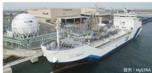
参考：神戸港で実証が進む液化水素の運搬船と貯蔵タンク
