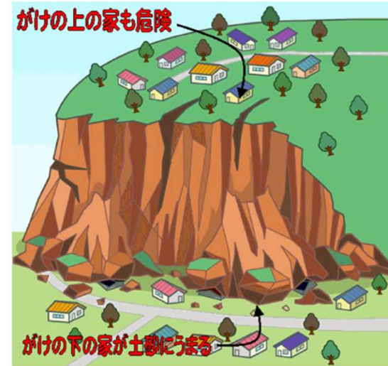
急傾斜地の崩壊
