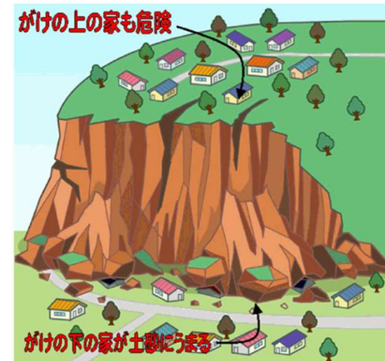
急傾斜地の崩壊
