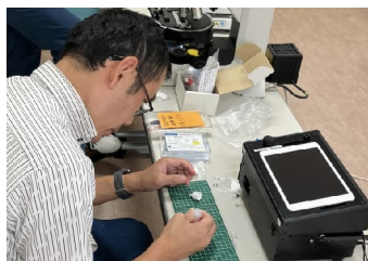
携帯型蛍光顕微鏡によりアスベスト漏洩の有無を確認
