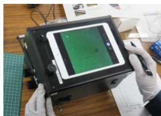
携帯型蛍光顕微鏡によりアスベスト漏洩の有無を確認
