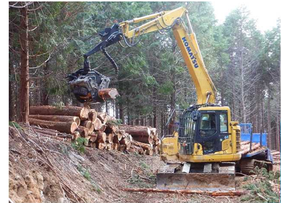
プロセッサによる造材 （神河町）
