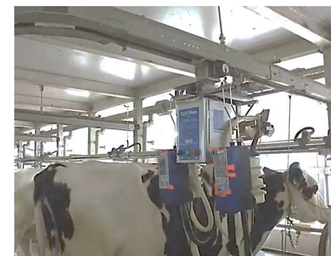
乳量測定機能によりミルクラーの自動離脱機能を備えた自動搬送装置（南あわじ市）
