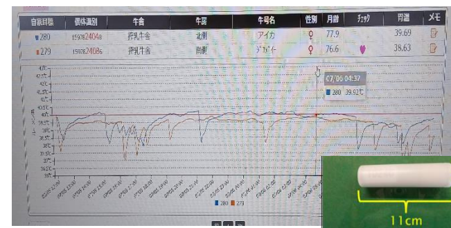
常時体温が分かる牛の胃内留置型センサーにより、分娩予測や体調変化を迅速に把握
