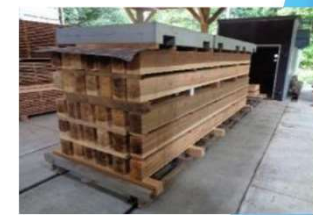
スギ平角の人工乾燥試験
