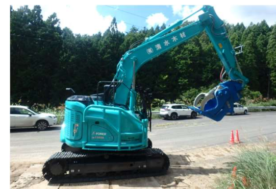
フェラーバンチャ（宍粟市） 立木をつかんで切り倒し、伐採木を集積整理・掘削バケットがついているため作業道開設に用いられる
