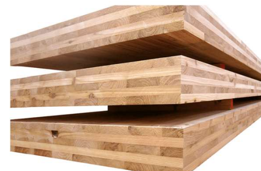
ラミナを交互に直交積層するCLT (日本CLT協会HPより)
