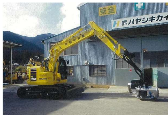
プロセッサ（宍粟市） 伐採された木をつかんで枝払い、玉切りして、所定の長さ（3m、4m等）の丸太に切り揃える
