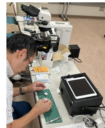
位相差・偏光顕微鏡（奥）及び携帯型蛍光顕微鏡（手前）によるアスベストの漏洩確認
