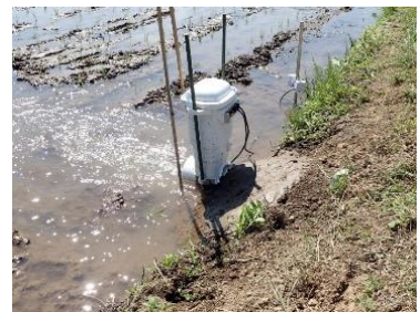
水田用自動給水機による水管理の実証 (養父市)
