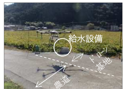
ドローンの離発着スペースや農薬散布時の希釈用給水設備を備えたドローン基地（姫路市夢前町宮置地区）
