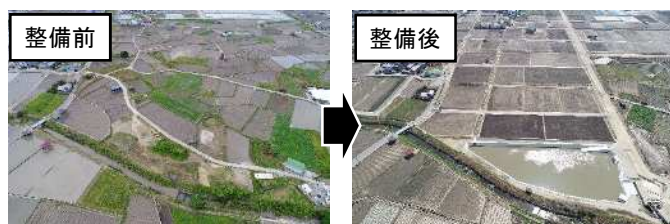
大区画化・整形田・農道整備により生産性を大幅に向上 (南あわじ市国衙地区)
