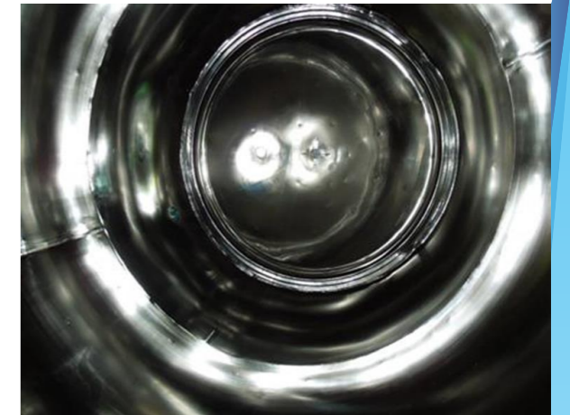
【環境・水素等新エネルギー】 表面処理により耐久性を強化したステンレスタンクの試作開発 (マルイ鍍金工業(株))
