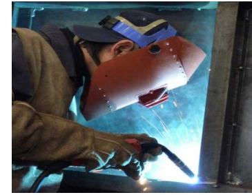
半自動溶接作業 (溶接コース)
