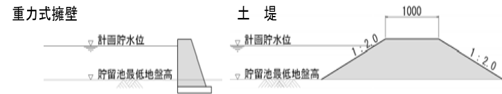
図-5 築堤の構造
