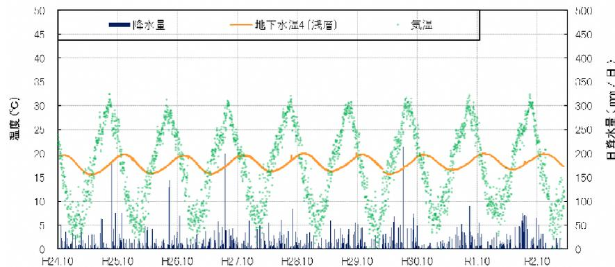
・水温は、15.5~20°Cの幅で変動する。周期性をもっており、気温と比較して概ね3か月ピークがずれている。
