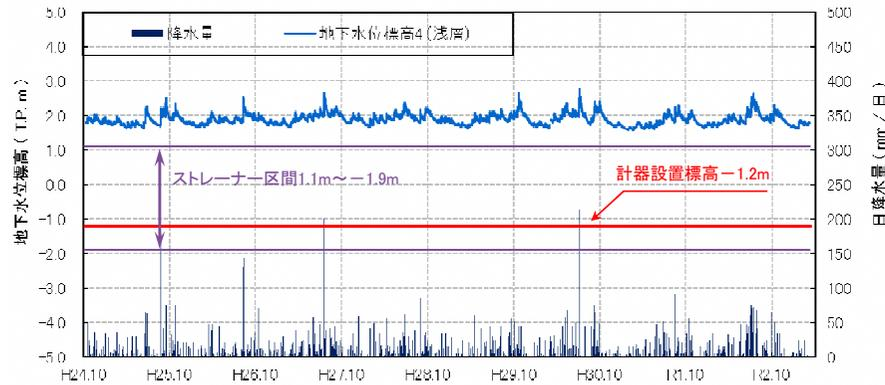
・地下水位は、降雨の影響により変動するものの、年間を通じて標高2.0m前後で安定している。変動幅は最大1m程度である。
