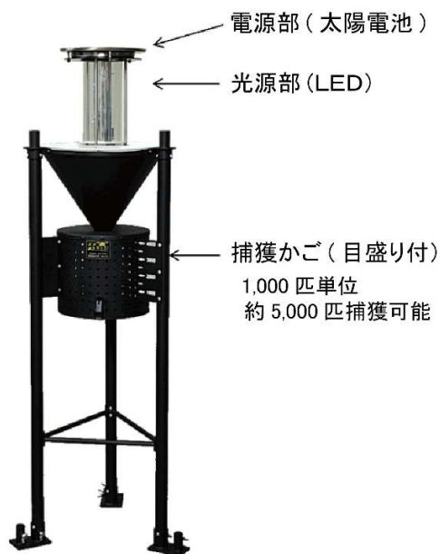
図 2-7 エコ虫トラップ (アオドウガネ捕獲用トラップ)
