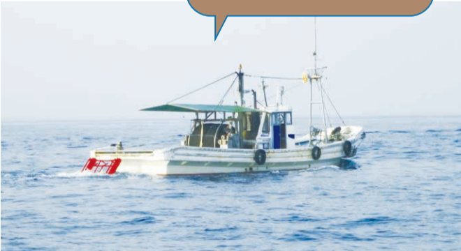
船尾に付く赤い器具が、海底を掘り起こす耕耘桁です。
