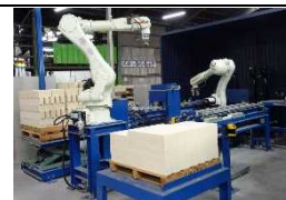
耐火煉瓦の自動選別積載ロボットシステムの立ち上げを支援
