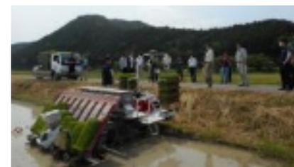
衛星画像による地力解析技術を利用した田植え同時可変施肥の実演
