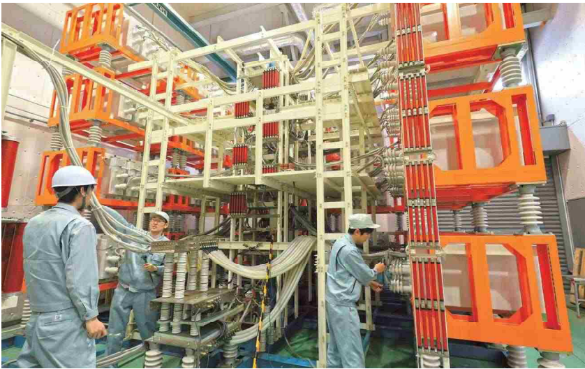
22万アンペアの直撃雷を発生させることができる、世界最大級の雷電流発生装置。
