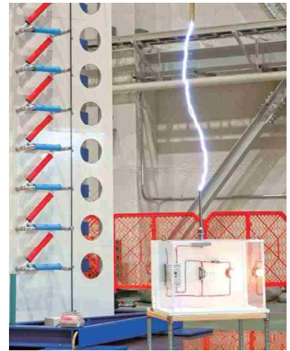
高電圧試験設備での放電実験の様子。雷の電圧を模擬的に再現し、得られたデータを製品開発などに生かしています。
