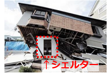
耐震シェルター家屋倒壊実験
