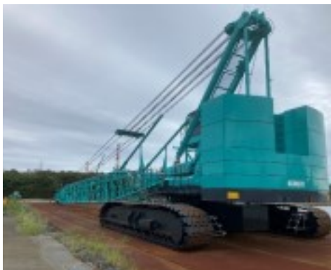
<200t 吊クローラクレーン>
