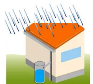
屋根に降った雨水を貯留
