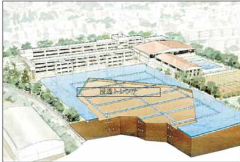
図 6.2.4 学校での浸透施設例（千葉県舟橋市）
