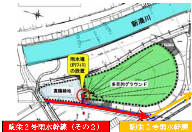
図 2.5.2 真陽南さくらグラウンドにおける流出調整機能施設(オリフィス)の整備予定箇所
