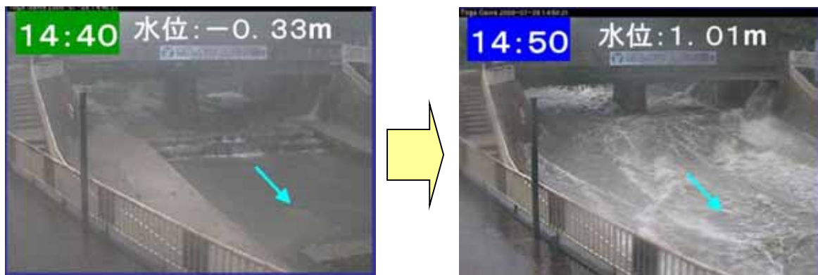
都賀川甲橋水位上昇状況（神戸市モニタリングカメラ画像）
