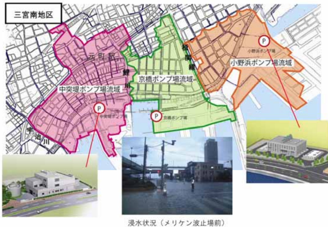
図 5.2.2 三宮南地区浸水対策事業概要図
