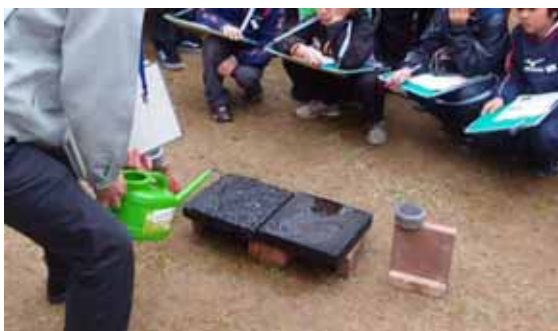
透水性舗装の違いを模型で実験
