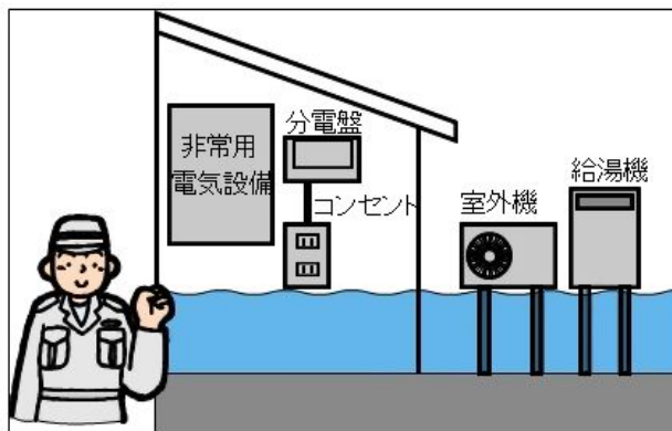
図 7.4.1 電気設備の浸水対策
