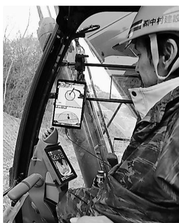
3次元設計データと建機の位置情報などをモニターで確認しながら作業するICT建機のオペレーター
