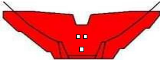
堰堤工  $H=11.0\text{m}$ 、 $L=50.0\text{m}$
