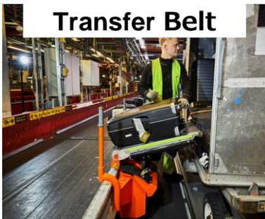
到着手荷物を返却ベルトへ流す作業を機械がアシストすることで、省力化と作業早期化
