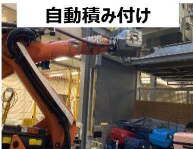
出発手荷物を機械が自動的にコンテナに積み付けることで、積み付け作業の省人省力化
