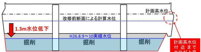
整備後の状況：断面が約1.8倍に拡大
