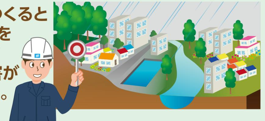
兵庫県では、1ヘクタール以上の開発に対しては、雨水の流出をおさえる池の設置を義務化しています。こうした池のことを「調整池」といいます。1ヘクタール未満の開発についても調整池の設置をすすめています。
